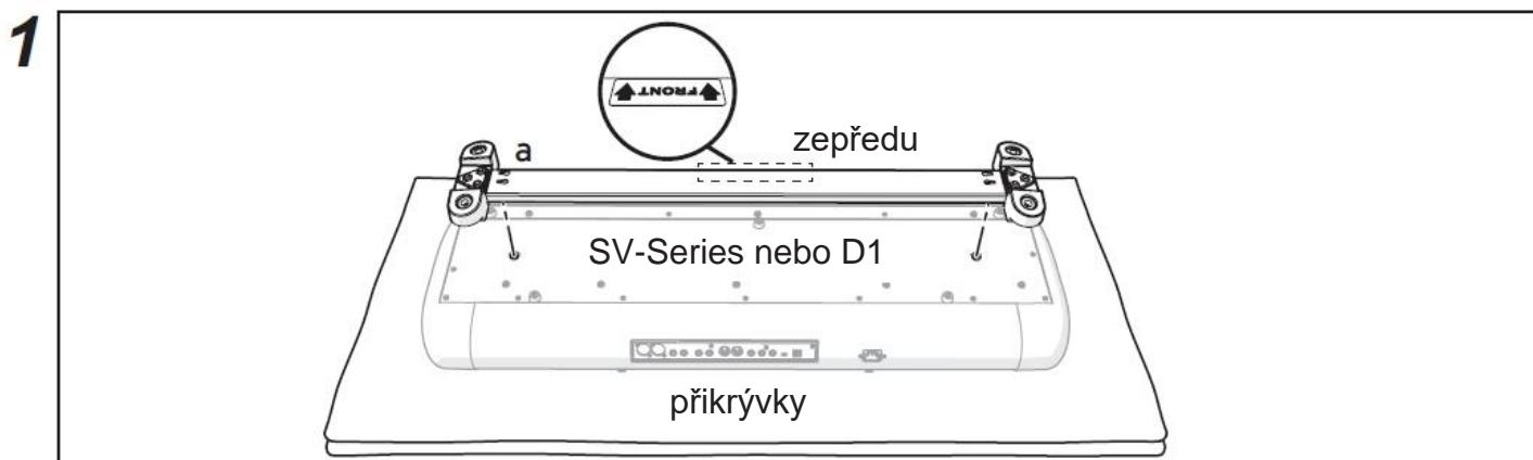
Abyste zabránili poškození nástroje i podlahy, rozprostřete na zem měkké pokrývky a nástroj umístěte na ně nohamu vzhůru. Při obracení jednotky dbejte opatrnosti, aby vám nevypadla.
